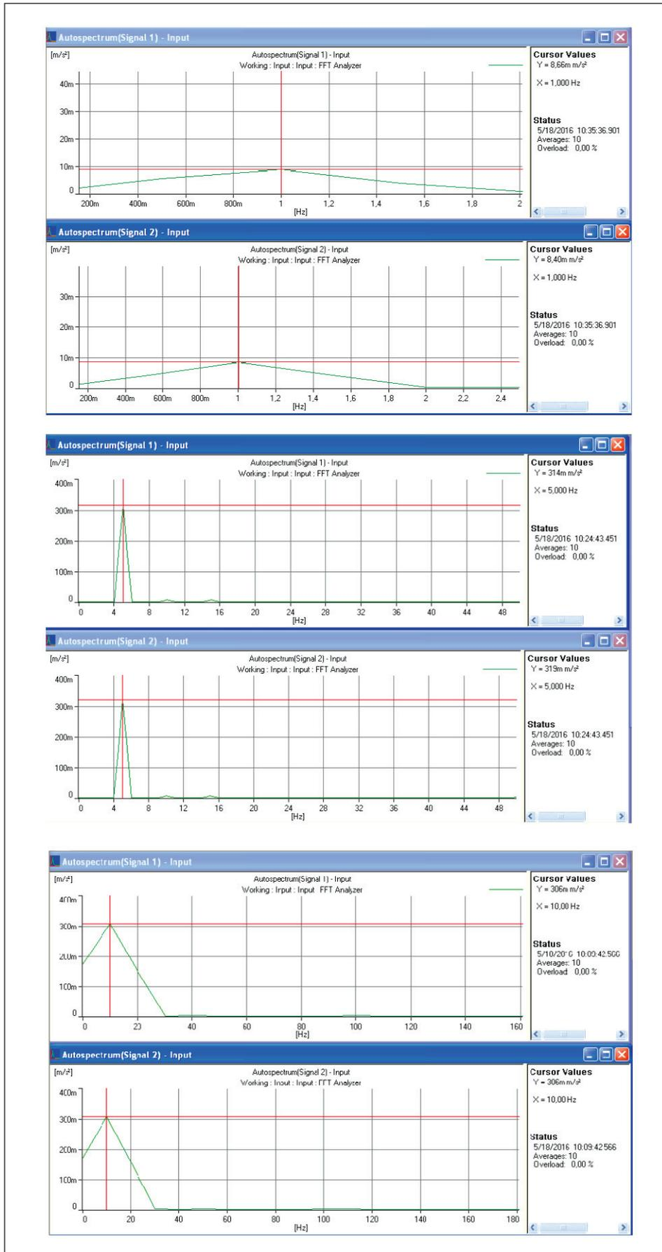
Gambar 11. Spektrum Sinyal Hasil Validasi *Accelerometer*
