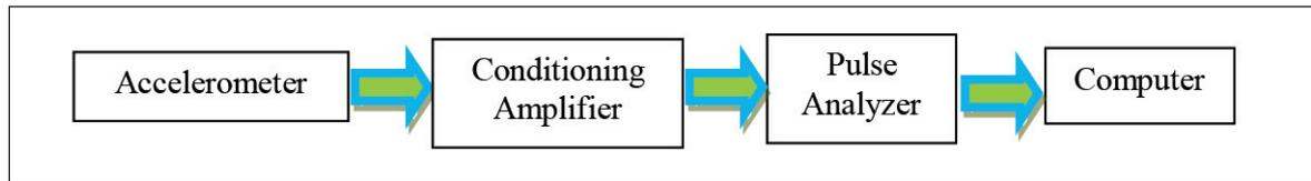
**Gambar 8.** Blok Diagram Pengondisi Sinyal
